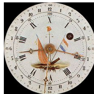
Cadran d'horloge affichant à la fois l'heure décimale (à l'intérieur du cercle) et l'heure duodécimale (sur le bord extérieur).
